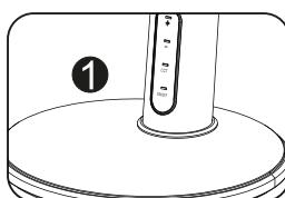
Vložte sloupek lampy do podstavce a ujistěte se o správné pozici usazení.
