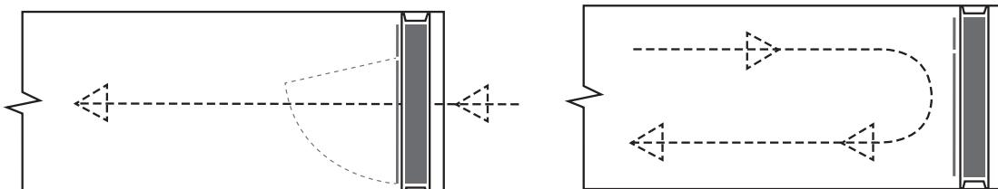
Die Klappe muss senkrecht oder bis 5° gegen die Luftstromrichtung installiert werden.
