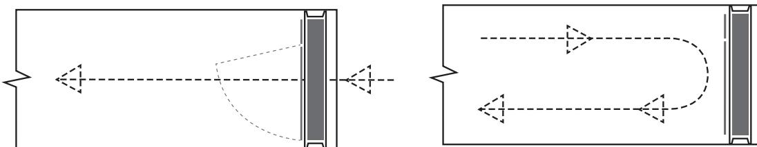
Clapeta trebuie instalat vertical sau, până la 5° față de direcția fluxului de aer.
