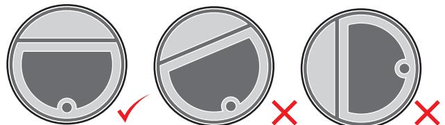
Eine verdrehte Installation verhindert die richtige Funktion der Klappe.
