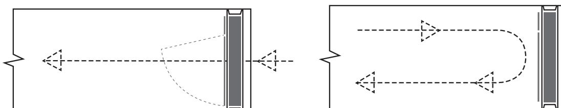
**Klapka musí být instalována svisle nebo do 5 ° proti směru proudění.**
