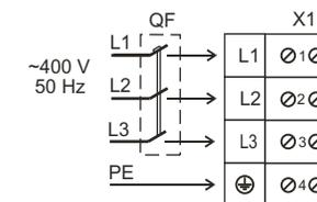
Schaltplan für die Ventilatoren FKO und FKO/400V
